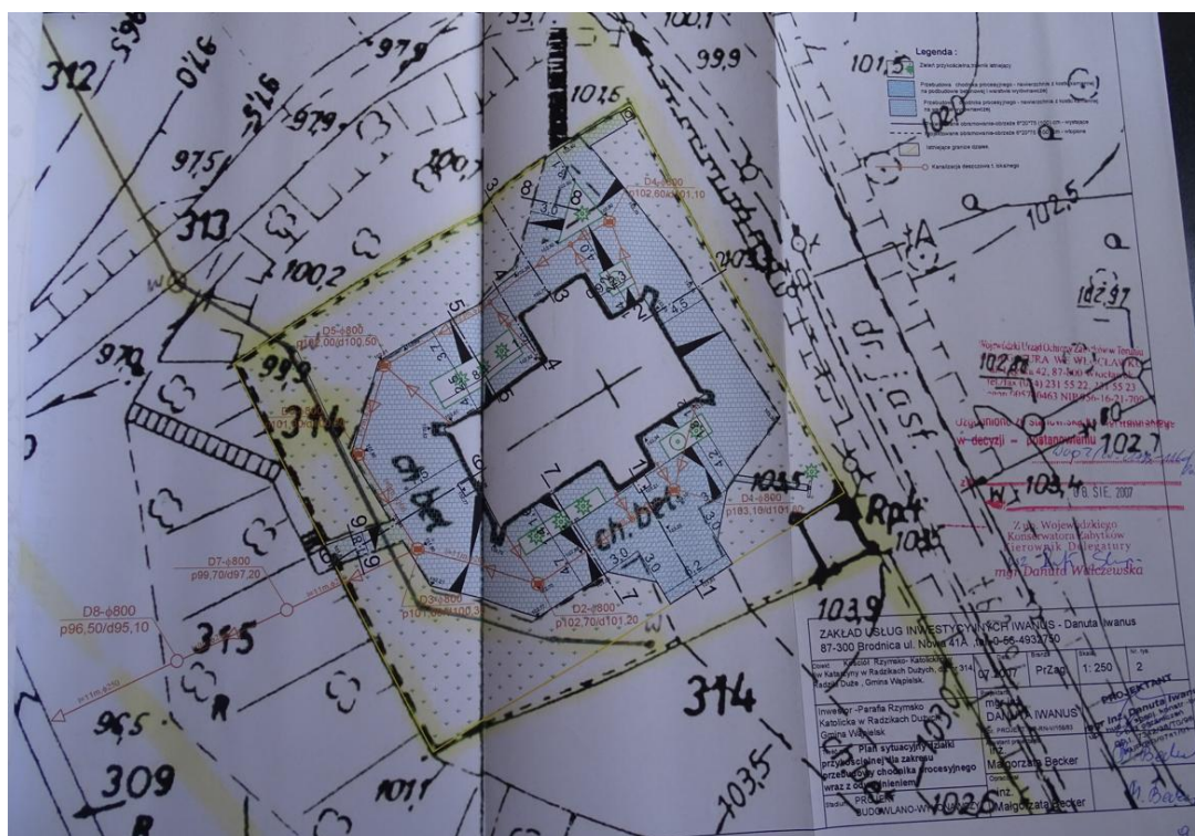
Plan sytuacyjny rozmieszczenia systemu odwodnienia oraz planowanej nawierzchni z kostki granitowej z 2007 roku.
